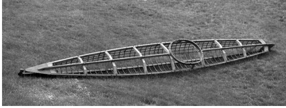
アリュート・バイダルカの骨組み。筆者制作
