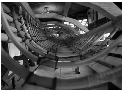
アリュート・バイダルカの骨組み。筆者制作
