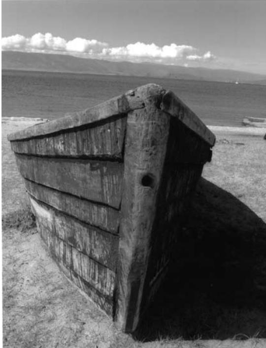
バイカル湖の船。クリンカービルドの様子。
