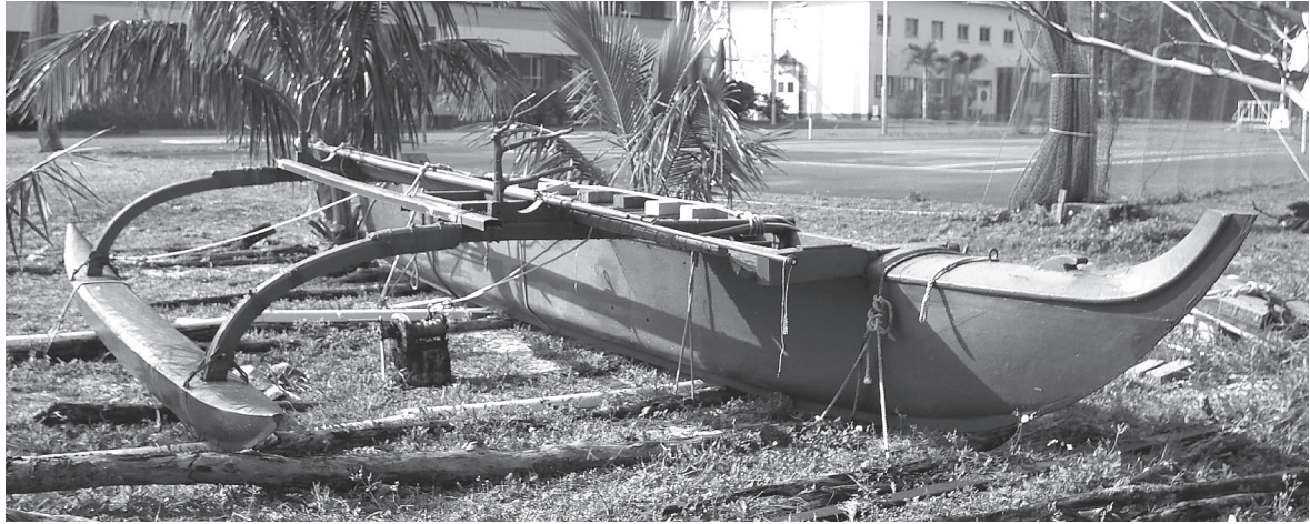
写真8 現在使用されているファイバーグラス製のカヌー。エンジン用で帆走はしないが、船尾に帆を張るためのロープを縛る突起の残存が残っている。モデルは図7のカヌー。(父島にて2008年3月、筆者撮影)
