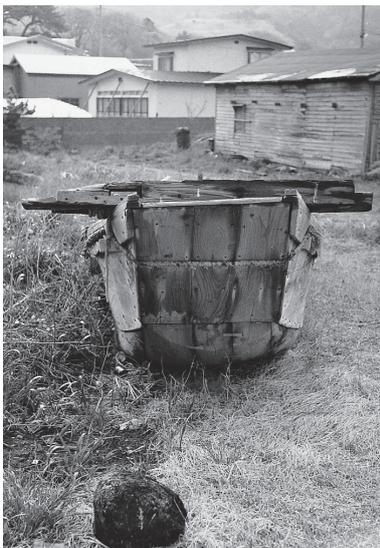
写真 1B 秋田県北浦のハタハタ船。割った船底材の側面から鎧張りに二段の舷側板を建ち上げている
