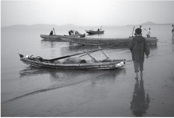
写真9 ベトナム・モンカイ海岸で使用される竹筏改良型漁船
