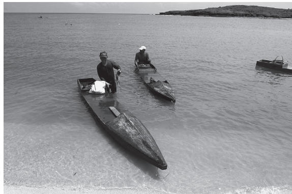
写真 14 イロコス海岸で使われる筏改良型の平底船
